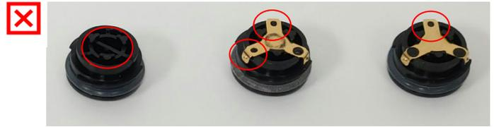
Tapón de la pila dañado: interrumpir el uso
