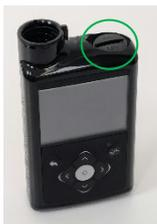
*El tapón de la pila se encuentra en la parte superior de la bomba, donde se sitúa el compartimento de la pila AA*
