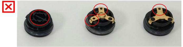
Tapón de la pila dañada: interrumpir el uso Falta el contacto metálico o alguno de los 3 puntos en relieve
