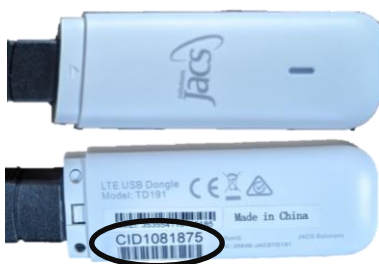
Figura 1. Imágenes de la parte frontal/parte posterior del adaptador para línea móvil 4G LATITUDE MIMIC; la etiqueta del CID incluye el número de serie.
