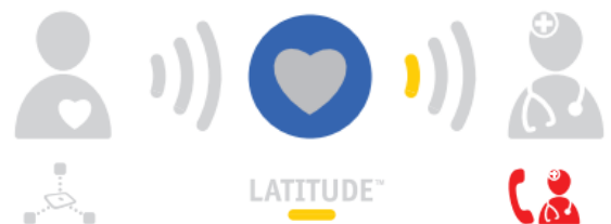
Figura 3. Superior: Si la transmisión de datos no se realiza correctamente durante la conexión al sistema LATITUDE, el comunicador mostrará una onda de envío de color amarillo. Inferior: Si no se transmite una condición de alerta roja del CIED, el comunicador mostrará el icono Llamar al médico de color rojo.
