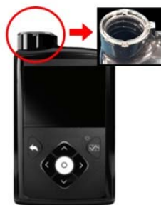
Imagen: Ubicación del anillo de retención en la bomba de insulina MiniMed™ serie 600
