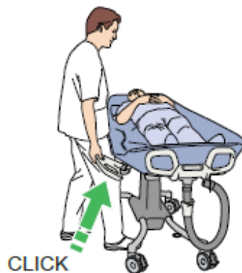
Imagen:1 . Pliegue el soporte lateral desde la posición abatida hacia abajo.
