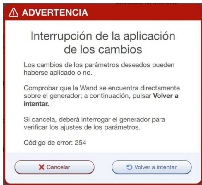
Figura 2: Mensaje de código de error 254 – Aplicación de cambios interrumpida encontrado durante la programación
